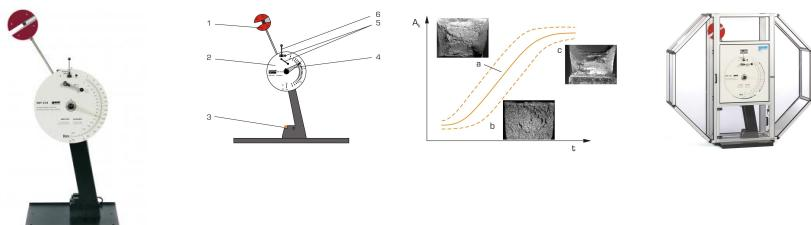
Dans le contrôle qualité industriel, l'essai de résilience est un essai très répandu; il permet de déterminer rapidement et simplement des valeurs caractéristiques pour l'évaluation de matériaux ou de composants.
