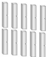
Ce jeu d'éprouvettes en V GUNT est disponible en accessoire pour l'appareil d'essai WP 400.
