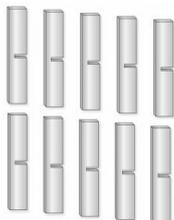
Ce jeu d'éprouvettes en R7 GUNT est disponible en accessoire pour l'appareil d'essai WP 400.
