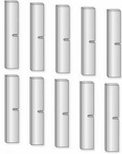
Ce jeu d'éprouvettes en U ISO est disponible en accessoire pour l'appareil d'essai WP 400.
