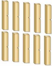
Ce jeu d'éprouvettes en V ISO est disponible en accessoire pour l'appareil d'essai WP 400.
