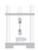
Cet accessoire, conçu pour lappareil dessai WP 310, permet de réaliser des essais de traction sur des éprouvettes cylindriques.
