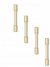
Ce jeu d'éprouvettes est disponible en accessoire pour l'appareil de essai WP 130.
