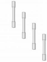
Ce jeu d'éprouvettes est disponible en accessoire pour l'appareil de essai WP 130.
