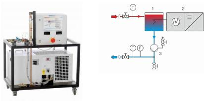
La fonction principale du WL 312.11 est de fournir un circuit deau froide pour les essais dans le WL 312 et le WL 315C. L'alimentation en eau froide permet de assurer un bon fonctionnement lorsque la température ambiante et celle de leau sont élevées.
