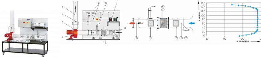
Le banc d'essai mobile permet d'étudier les relations du transfert thermique par convection forcée.
