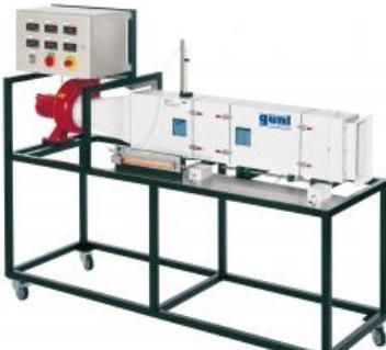
Le banc d'essai est constitué d'un canal isolé, à travers lequel de l'air est aspiré à l'aide d'un ventilateur. Différents éléments échangeurs de chaleur peuvent être placés dans le canal d'air:
