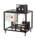
La fonction principale du WL 312.12 est de fournir de lagent réfrigérant comprimé et ensuite condensé pour les essais dans le WL 312.
