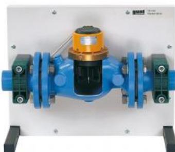
Véritable compteur à eau transformé en modèle en coupe. Avec roue à ailettes et transducteur de mesure inductif. Raccords bridés DN 50, monté sur un panneau de démonstration. Le fonctionnement de toutes les pièces mobiles est conservé.
