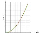
La force centrifuge se forme lors du mouvement d'un corps rigide sur une trajectoire circulaire, et correspond à la force d'inertie exercée vers l'extérieur, dans la direction opposée au centre de rotation.
