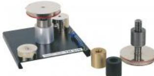
L'appareil de base est constitué pour l'essentiel d'un couplage broche filetée - écrou en position verticale. Un couple est exercé sur une broche par le biais d'une poulie, à l'aide de la balance à ressort et du câble. Des poids additionnels sur le plateau rotatif influent sur la charge axiale du filet.
