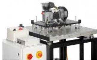
Un compresseur à piston est typique une machine sur laquelle les balourds et les masses oscillantes génèrent des vibrations.
