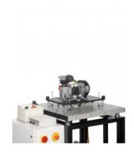
Un compresseur à piston est typique une machine sur laquelle les balourds et les masses oscillantes génèrent des vibrations.
