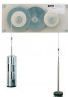
Les roues dentées et les engrenages à roues dentées sont des éléments de machine, et font partie des éléments de transmission ou éléments de transformation.
