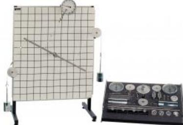
**Equilibre des forces, des moments, de la décomposition des forces, du principe de levier**
