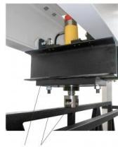
Cet accessoire pour SE 100 comprend un dispositif de charge à entraînement hydraulique.
