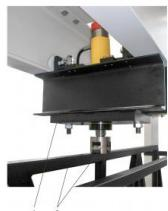
Cet accessoire pour SE 100 comprend deux dispositifs de charge à entraînement hydraulique.
