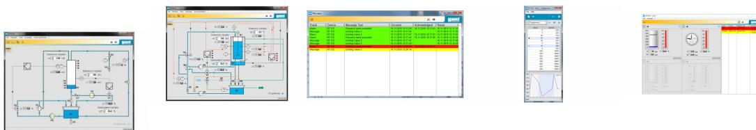
Le logiciel de conduite de procédés RT 650.60 (SCADA) a été spécialement conçu pour RT 681 et RT 682.
