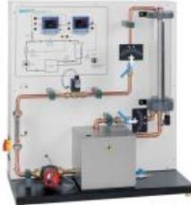
**Déconnexion possible du régulateur interne pour utiliser un régulateur externe, mesure par fiche 4mm**
