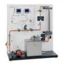
L'appareil d'essai constitue une introduction expérimentale étendue aux principes de base de la technique de régulation à l'exemple d'une régulation combinée de débit et de niveau.
