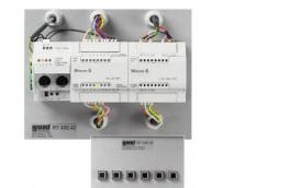
L'automate programmable industriel (API) est installé d'origine sur une plaque qui se fixe facilement et rapidement sur le bâti du module de base RT 450.
