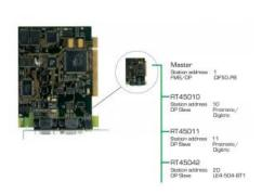
La communication entre un PC et des composants dautomatisation via un bus de terrain constitue une solution standard
