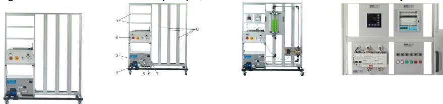
Le module de base RT 450 est constitué avec de nombreux composants et accessoires, d'un système de travaux pratiques modulaire, entièrement flexible et ouvert pour acquérir expérimentalement les principes de base de l'automatisation de procédés.
