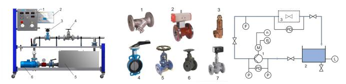
RobineStrains Source: 1 collectour d'impurelles, 2 robinetá broumant sphérique, 3 soupape de sécurité, 4 clapet, 5 soupape d'arrêt, rôbines d'arrêt, robines d'
