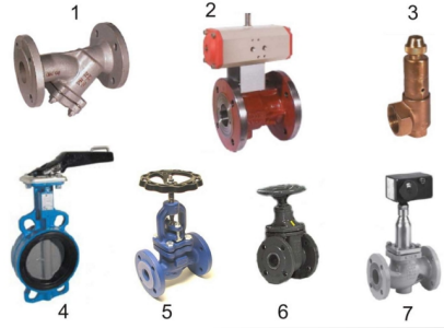
Robinetteries fournis: 1 collecteur d'impuretés, 2 robinet à tournant sphérique, 3 soupape de sécurité, 4 clapet, 5 soupape d'arrêt, 6 robinet-vanne à coins, 7 vanne de régulation électrique
