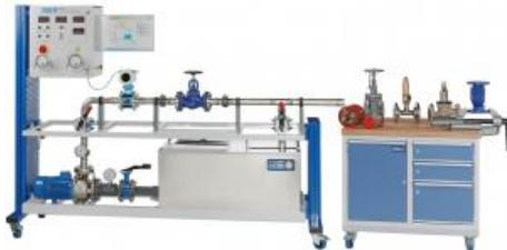
Le banc dessai RT 396 permet la comparaison de différentes robinetteries du point de vue de leurs caractéristiques. Les quatre catégories typiques de robinetteries, robinet, robinet-vanne, clapet et soupape sont représentées par un robinet à tournant sphérique, un clapet, un robinet-vanne, une soupape d'arrêt et une vanne de régulation. On examine en outre une soupape de sécurité et un collecteur d'impureté.
