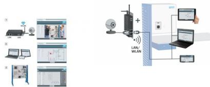
Le logiciel Web Access Software permet de connecter l'appareil dessai à la Web Access Box GU 100.
