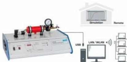
Le RT 030 propose des essais de base sur un système réglé de pression.
