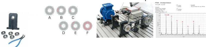
L'analyse des vibrations est un outil important pour juger l'état d'un palier à roulement.
