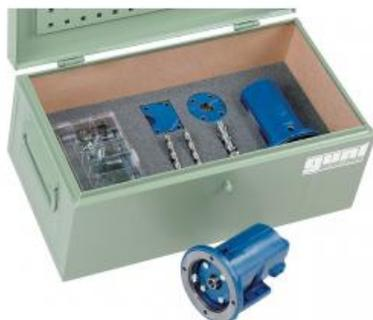
Les pompes à vis font partie des pompes volumétriques et fonctionnent à rotation, à aspiration normale.
