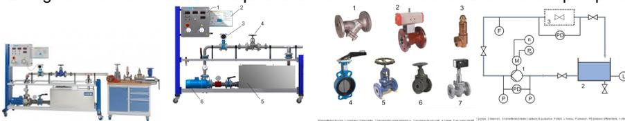
Le banc d'essai RT 396 permet la comparaison de différentes robinetteries du point de vue de leurs caractéristiques.
