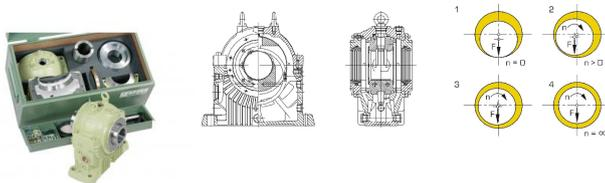
Sur les paliers lisses, un mouvement de glissement a lieu généralement entre un tourillon et un coussinet de palier.
