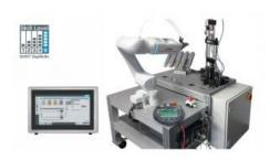
La fonction principale de linstallation dessai IA 500 est de transformer un processus manuel dans le cas présent, un essai de traction classique
