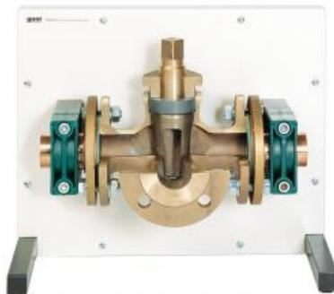
Véritable robinet à 3 voies transformé en modèle en coupe.
