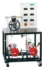
1 compresseur, 2 poêle de courroie, 3 Réservoir d'aspiration, 4 soupape de purge avec silencieux, 5 soupape de sécurité, 6 réservoir sous pression, 7 pressostat, 8 électrovanne, 9 armure de commande avec affichage numérique
