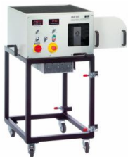
1 élément d'affichage et de commande, 2 broche du dispositif de tension de la courroie trapézoïdale, 3 résistance de charge, 4 fermeture à genouillère, 5 entretoise de montage du dispositif de tension, 6 trappe de service transparente, 7 tôle de protection de la courroie trapézoïdale
