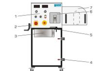
1 élément d'affichage et de commande, 2 broche du dispositif de tension de la courroie trapézoïdale, 3 résistance de charge, 4 fermeture à genouillère, 5 entretoise de montage du dispositif de tension, 6 trappe de service transparente, 7 tôle de protection de la courroie trapézoïdale
