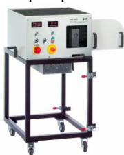
1 élément d'affichage et de commande, 2 broche du dispositif de tension de la courroie trapézoïdale, 3 résistance de charge, 4 fermeture à genouillère, 5 entretoise de montage du dispositif de tension, 6 trappe de service transparente, 7 tôle de protection de la courroie trapézoïdale
