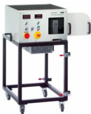
1 élément d'affichage et de commande, 2 broche du dispositif de tension de la courroie trapézoïdale, 3 résistance de charge, 4 fermeture à genouillère, 5 entretoise de montage du dispositif de tension, 6 trappe de service transparent, 7 tôle de protection de la courroie trapézoïdale
