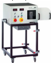
1 élément d'affichage et de commande, 2 broche du dispositif de tension de la courroie trapézoïdale, 3 résistance de charge, 4 fermeture à genouillère, 5 entretoise de réglage du dispositif de tension, 6 trapèze de service transparent, 7 tôle de protection de la courroie trapézoïdale
