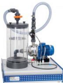
L'unité d'alimentation HM 290 est requise pour l'alimentation de diverses turbines. En plus, l'unité d'alimentation permet de réaliser des essais de base sur une pompe centrifuge.
