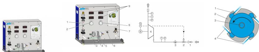
Sur les turbines à réaction, la pression statique du milieu de travail est plus élevée devant que derrière le rotor.
