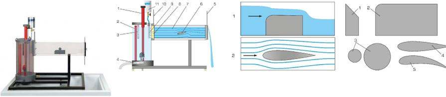
Le banc d'essai HM 150.21 permet de visualiser les écoulements autour de corps de résistance et les phénomènes de décollement dans des canaux ouverts.
