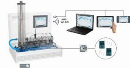
Dans le cas d'un écoulement horizontale d'un réservoir, la forme de la sortie et la vitesse de l'écoulement agissent sur la trajectoire du jet d'eau.
