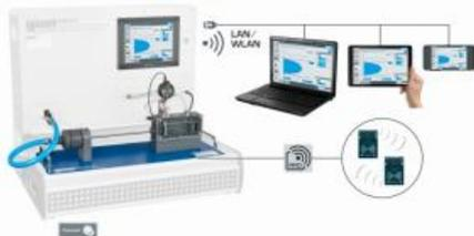
Le HM 250.02 est utilisé pour étudier le profil d'écoulement. Il est ainsi possible de mesurer les différences dans la formation de l'écoulement.
