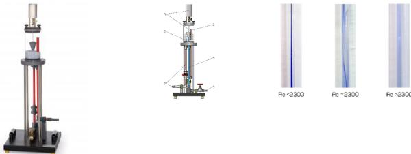
Un écoulement laminaire et un écoulement turbulent sont représentés durant l'essai d'Osborne Reynolds. On peut alors observer, à partir d'une vitesse seuil, la transition entre écoulement laminaire et écoulement turbulent. Pour déterminer si un écoulement est laminaire ou turbulent, on utilise le nombre de Reynolds.
