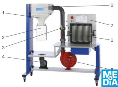
1 buse, 2 section de mesure à monter, 3 thermomètre, 4 tuyau d'air extrait, 5 ventilateur radial, 6 manomètre à tubes, 7 coffret de distribution avec ajustage de la vitesse, 8 chambre de stabilisation avec redresseur d'écoulement
