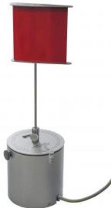
Un corps de portance ou de résistance est utilisé dans le capteur de force HM 170 qui émet la force de traînée et de portance comme valeur mesurée lors de l'écoulement le long du corps.
