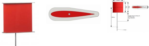
Le corps de portance aile est étudié dans la section de mesure de la soufflerie HM 170.
