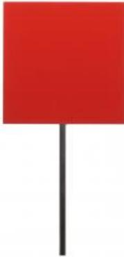
Le corps de portance carré percé est étudié dans la section de mesure de la soufflerie HM 170. Le corps de portance se compose d'un carré percé en tôle d'acier et d'une barre de maintien en acier inoxydable. Le carré percé est peint en rouge. Le corps de portance est placé dans le capteur de force qui mesure la force de traînée et la portance opposée par le corps à l'écoulement.
