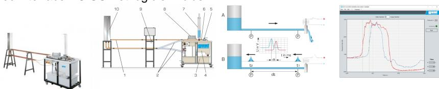
Dans les installations industrielles de type centrales hydro-électriques ou dans les systèmes d'alimentation en eau, les variations du débit entraînent des variations de la pression.
