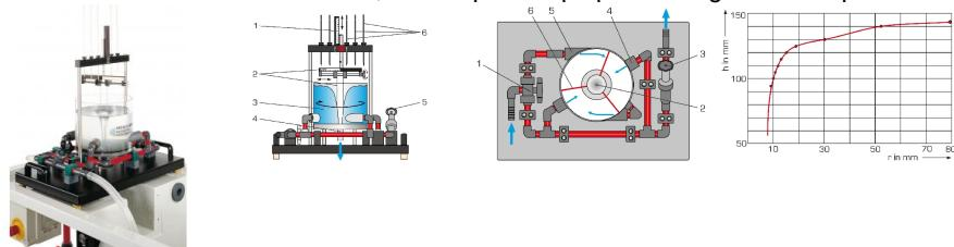
En mécanique des fluides, les écoulements circulaires dun fluide qui se forment sous leffet de gradients de vitesses suffisamment élevées sont appelés tourbillons.
