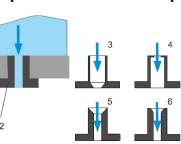
Les pertes de charge lors de la vidange sont liées principalement à deux processus: la déviation du jet à l'entrée dans l'orifice et le frottement des parois dans l'orifice.
