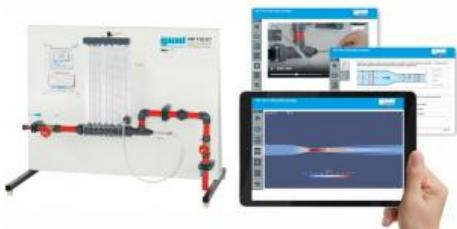
Le théorème de Bernoulli décrit le rapport existant entre la vitesse découlement dun fluide et sa pression. Ainsi, une augmentation de la vitesse du fluide circulant entraîne une chute de pression statiques et inversement. La pression totale du fluide reste elle constante.
