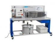
Dans les réservoirs de sédimentation, les matières solides présentes dans les suspensions sont séparées sous leffet de la force de gravité.
