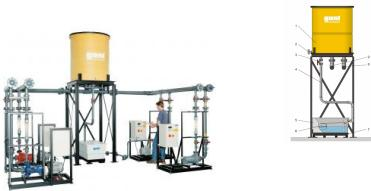
Les bancs de montage HL 962 sont reliés à l'aide d'éléments de tuyauterie HL 962.32 pour former une installation complexe de conduites et de pompes.
