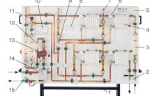
1 SSI, 2 raccords d'eau froide, 3 robinetterie, 4 échangeur de chaleur à plaques, 5 panneau, 6 vanne thermostatique, 7 purge d'air, 8 vannes de température et local, 9 thermomètres, 10 radiateurs, 11 vanne de purge, 12 vanne de purge, 13 vanne de purge, 14 vanne de purge, 15 vanne de purge, 16 raccords d'eau de chauffage
