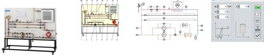
Le banc d'essai contient un cycle complet et fermé avec pompe de circulation, dispositif de chauffage électrique, convecteur pour émission de chaleur, différentes sections de tuyau, armatures et éléments de sécurité.
