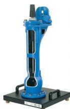
Véritable prise d'eau souterraine transformée en modèle en coupe. Avec raccord à bride, montée sur un socle. Le fonctionnement de toutes les pièces mobiles est conservé.
